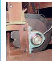
Podmazivanje ležaja industrijske peći, koje spriječava zaustavljanje strojeva
